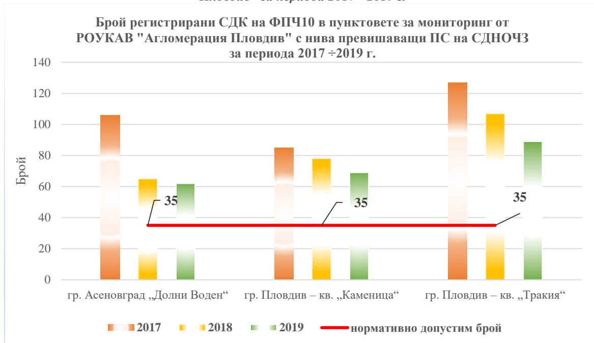
Фигура 12 Брой регистрирани превишения на СДК на ФПЧ 10 в пунктовете от "Агломерация Пловдив" за периода 2017 - 2019 г.
